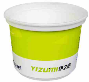
产品名称：微发泡日化容器 生产机型：PAC250K高速包装注塑机 成型腔数：一出二 容量：1L 重量：25.6g 周期：6.5s
