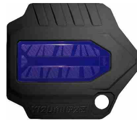
产品名称: 汽车发动机盖 生产机型: UN500DP 两板式注塑机 成型模具: InPUR “1+2” 创新模具 材料: AKROMID® B3 GF 15 1 black + SHGPuR 产品尺寸(LxWxH): 400x350 x25 mm 重量: 475g 成型周期: 60s
